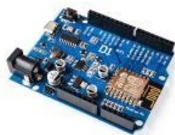
Fig. 2. ESP8266 WeMos D1 board
